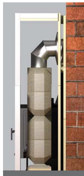
Řez trojvrstvou konstrukcí zadní stěny
